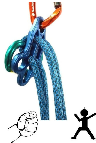
FIGURE / FIGURA 3: belay for climbing with one or two ropes. The parallel slots have round or pointed ends, which provide different friction options, depending which side of the Bugaboo (“head” or “foot”) is facing down. / Segurança para escalada com uma ou duas cordas. As fendas paralelas tem terminações pontudas ou arredondadas que proporcionam diferentes opções de fricção dependendo de qual lado do Bugaboo (“cabeça” ou “pé”) está virado para baixo.
