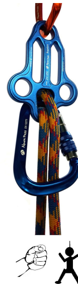
FIGURE / FIGURA 4: you have the option to belay a climber using the “head” of the Bugaboo for climbing with intermediate thickness rope. It is one more option, but remember that it is harder to disengage the device. / Você tem a opção de utilizar a “cabeça” do Bugaboo para a segurança na escalada com corda intermediária. É mais uma opção, contudo, lembre-se que, desta forma, é mais difícil de destravar o aparelho.
