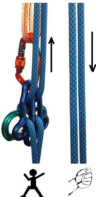
FIGURE / FIGURA 7: lowering one or two people from the anchor point you will change the sides (opposite from the belaying system) and use the redirect technique. / para descer uma ou duas pessoas a partir da ancoragem, você deverá inverter as posições da corda (em relação à segurança para escalada – compare com a figura 3) e utilizar a técnica de redirecionamento.
