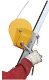
Photo/Foto 5: positioning the winch handle. Fixação da alavanca do guincho.
