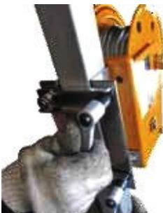
Photo/Foto 4: positioning the winch. Fixação do guincho.
