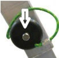
Photo/Foto 3: how to set the height of the tripod legs. Como ajustar a altura das pernas do tripé.
