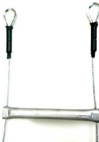
Foto 1: alças para a conexão da escada. Nunca utilize apenas uma alça para a conexão da escada. É necessário conectar as duas alças à ancoragem, por meio mosquetões ou malhas rápidas.
