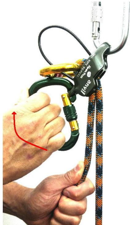
FIGURE / FIGURA 3: how to lower a climber that is hanging from the rope. The braking hand keeps holding the rope!. Como baixar um escalador pendurado na corda. A mão de freio permanece segurando a corda!
